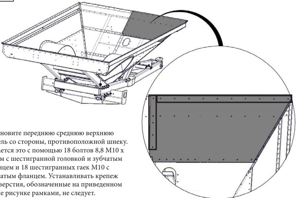
Установите переднюю среднюю верхнюю панель со стороны, противоположной шнеку. Делается это с помощью 18 болтов 8,8 М10 х 25 мм с шестигранной головкой и зубчатым фланцем и 18 шестигранных гаек М10 с зубчатым фланцем. Устанавливать крепеж в отверстия, обозначенные на приведенном выше рисунке рамками, не следует.
